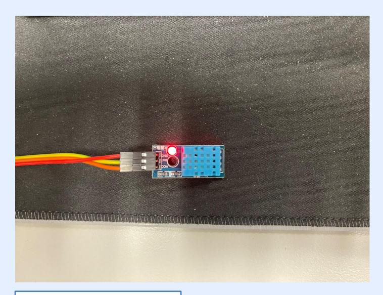
DHT11 humidity/temperature sensors
